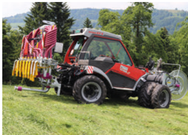
Auf den Dreipunktbock kann auch eine Hochdüse montiert werden
