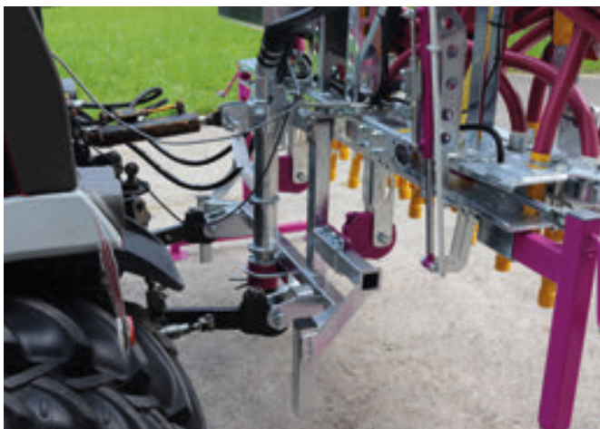
Dreipunktbock mit Einlaufrohr (mit diversen Optionen erhältlich)
